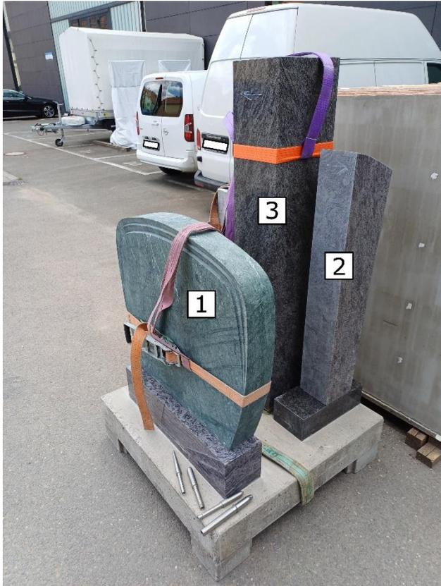
Bild 5: Aufgestellte Grabmale 1, 2, 3 (Fundament, Sockel, Dübel und Grabstein)
